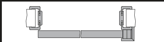
Schiebetür vor der Wand laufend mit Anschlagkasten
